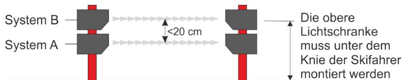
Bei der Sender/Empfänger-Type können die Sender der Lichtschranke entweder auf der gleichen Seite sein oder gegenüber (siehe Bedienungsanleitung des Herstellers). Die Lichtschranken können gekreuzt aufgestellt werden, aber in allen Fällen muss der maximale Abstand von 20 cm berücksichtigt werden.
